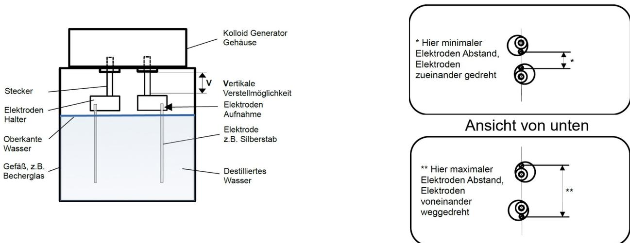
Bitte achten Sie darauf, dass die Elektrodenhalter selbst niemals das Wasser berühren, sondern mindestens 3 mm über der Wasseroberfläche positioniert sind!
